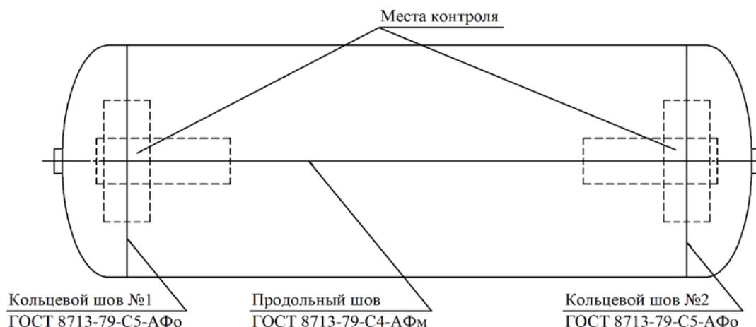
Эскиз к разделу "5. Данные о неразрушающем контроле сварных соединений"
